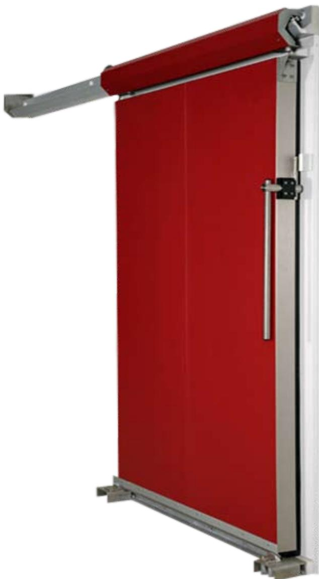
**Marco:** Perfil de aluminio extrusionado y posteriormente lacado en Blanco, con doble rotura de puente térmico. Este marco tiene la posibilidad de equiparse con resistencia para evitar la congelación del burlete en las cámaras de baja temperatura. Es adaptable a cualquier panel o a obra civil.
