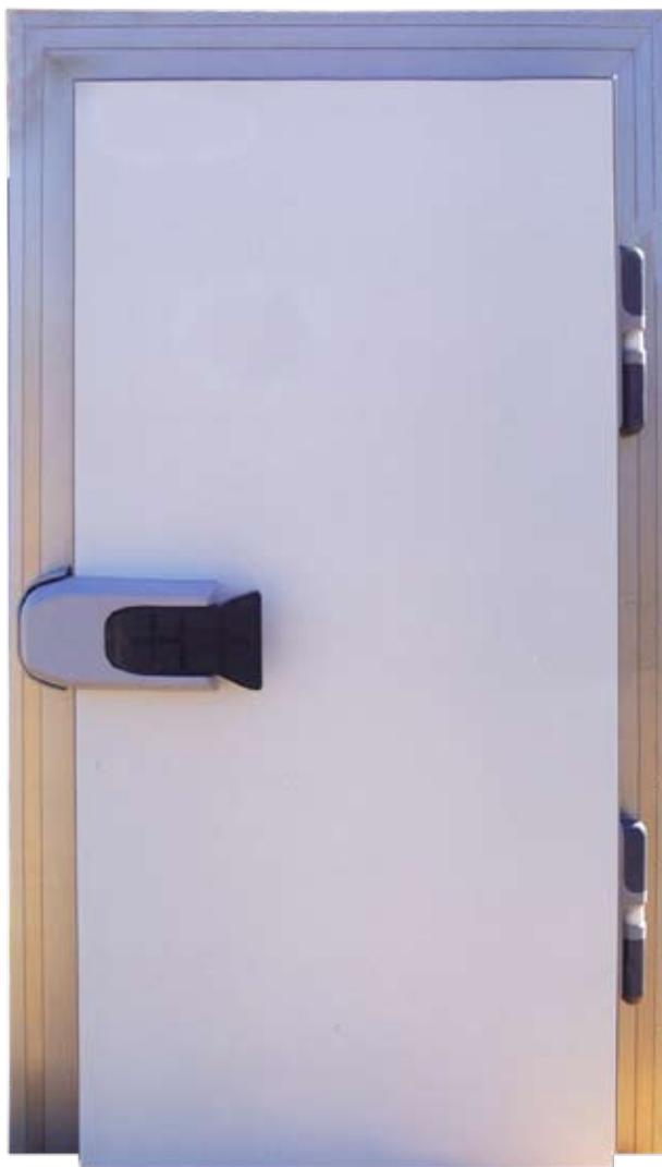
**Marco:** Perfil de aluminio extrusionado y posteriormente lacado en Blanco, con doble rotura de puente térmico. Este marco tiene la posibilidad de equiparse con resistencia para evitar la congelación del burlete en las cámaras de baja temperatura.
