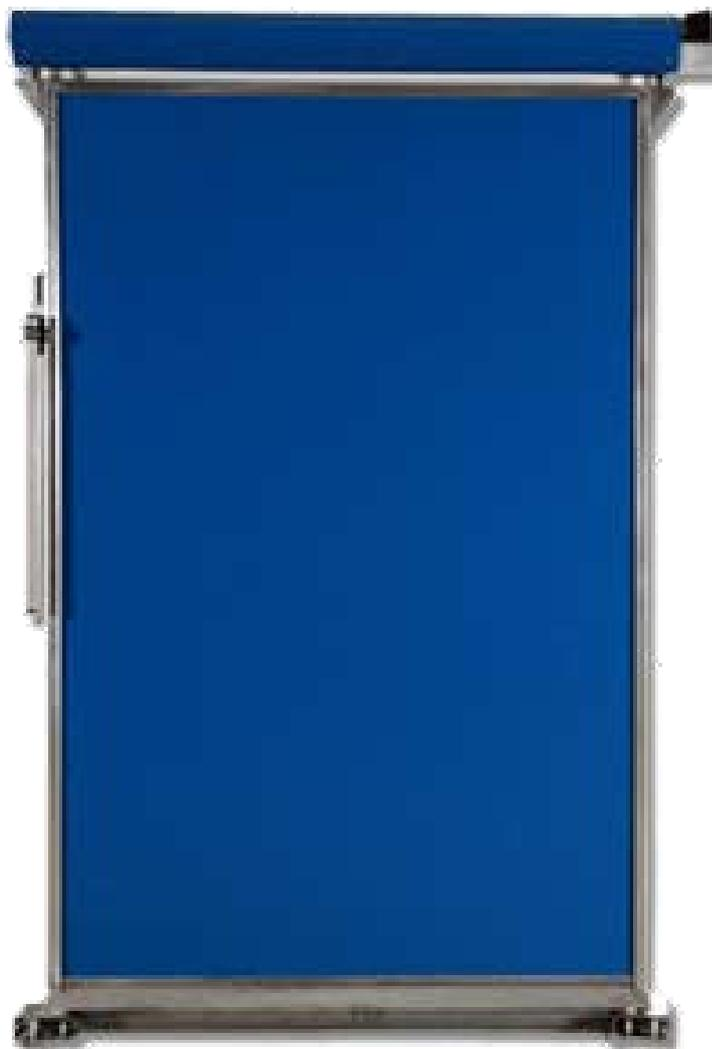
**Marco:** Perfil de aluminio extrusionado y posteriormente lacado en Blanco, con doble rotura de puente térmico. Este marco tiene la posibilidad de equiparse con resistencia para evitar la congelación del burlete en las cámaras de baja temperatura. Es adaptable a cualquier panel o a obra civil.
