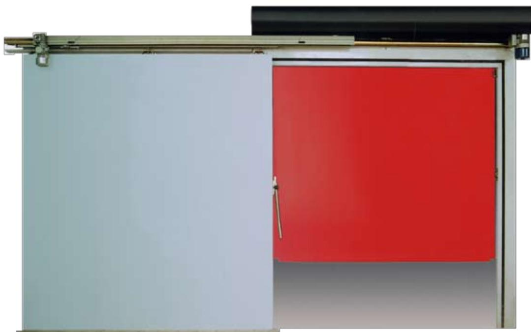
**Marco:** integra el cierre de la puerta frigorífica positiva o negativa y el guiaje de la lona de la puerta rápida. Estas guías van calefaccionadas en caso de baja temperatura. Realizado con materiales que proporcionan una rotura de puente térmico entre el interior y el exterior de la cámara frigorífica. Acabados en inox., prelacado,...
