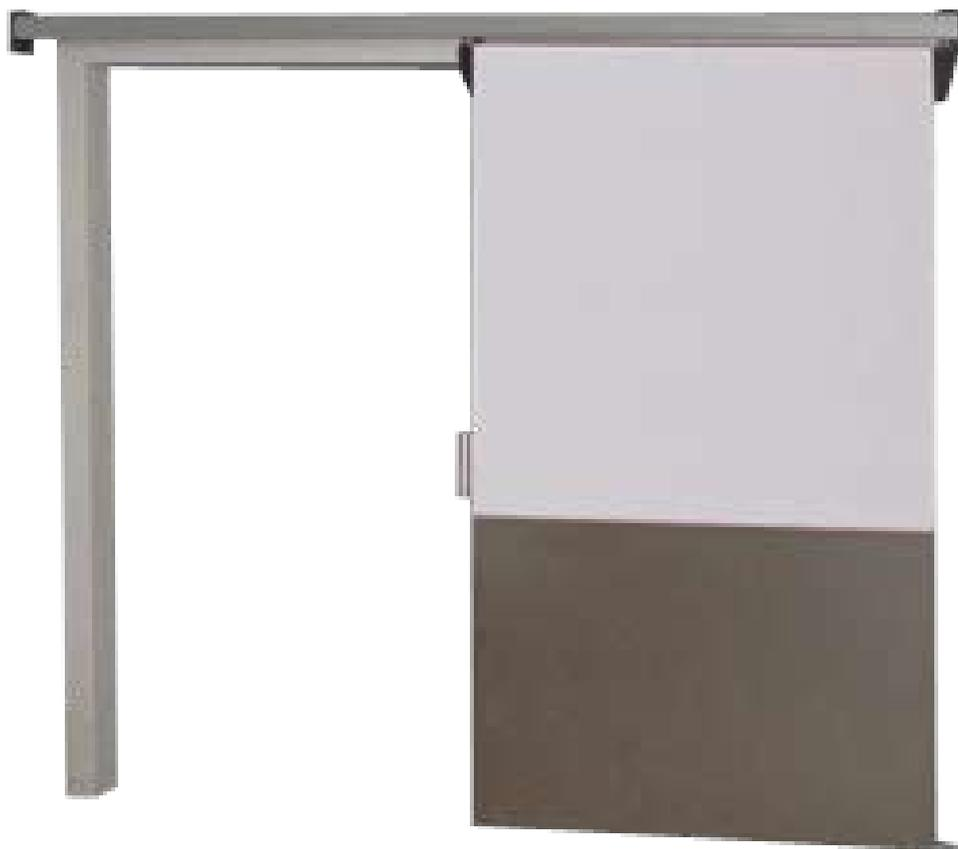
**Marco:** Perfil de aluminio extrusionado y posteriormente lacado en Blanco, con doble rotura de puente térmico. Este marco tiene la posibilidad de equiparse con resistencia para evitar la congelación del burlete en las cámaras de baja temperatura. Es adaptable a cualquier panel o a obra civil.
